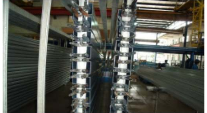
图1 夹子双面上排方式
